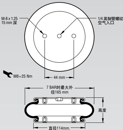
注：图示为缘板气囊。此零件也可提供缘环结构。不包括螺钉。参见第8-10页的说明。
