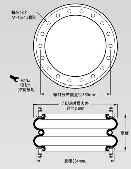
注:图示为缘环气囊。此零件也可提供轧制板结构。参见第 11页的说明。
